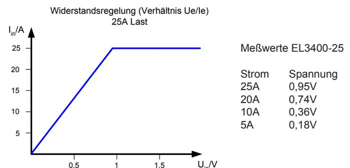
Hinweis: die Meßwerte beziehen sich auf aktuell eingesetzte Endstufentransistoren (Stand Juni 2008). Sollten Ihre Werte abweichen, so haben sie eine ältere Last mit anderen Transistoren.
